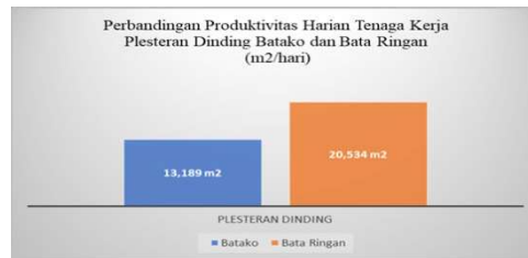
Gambar 4. Perbandingan Produktivitas Harian Tenaga Kerja Pekerjaan Plesteran Dinding Batako dan Bata Ringan
