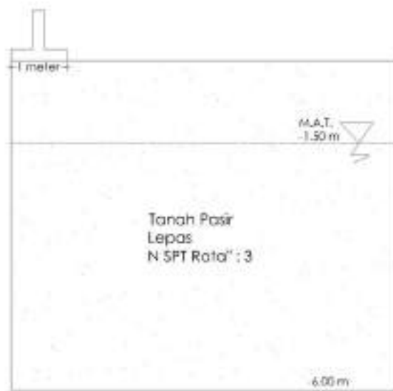
Gambar 4. Geometri Lapisan Tanah untuk Perhitungan Daya Dukung Tanah
