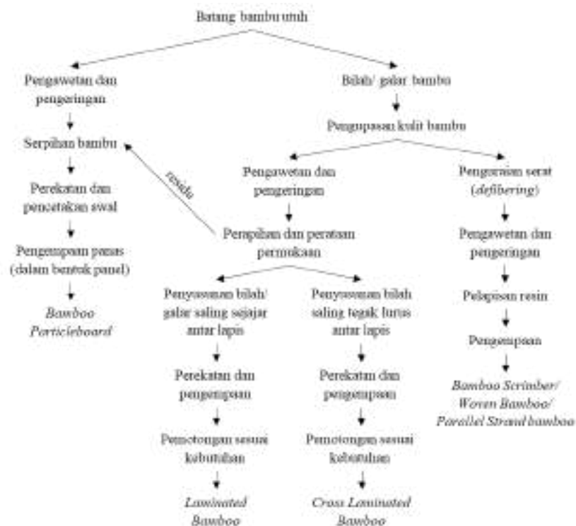
Gambar 1. Bagan alir pembuatan produk bambu rekayasa (dari berbagai sumber)
