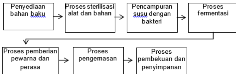
Gambar 2. Alur proses produksi frozen yoghurt
