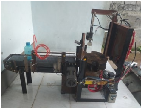
Gambar 2. Pengisian air dan penutup botol otomatis berbasis PLC
