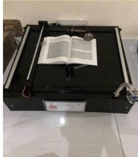
**Gambar 2.** Konstruksi alat page flipper
