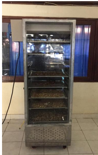
Gambar 10. Jahe segar didalam alat pengering jahe sistem dehumidifikasi
