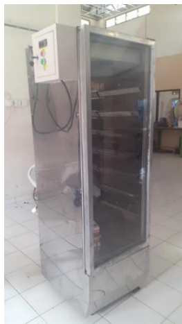
Gambar 8. Alat pengering jahe sistem dehumidifikasi
