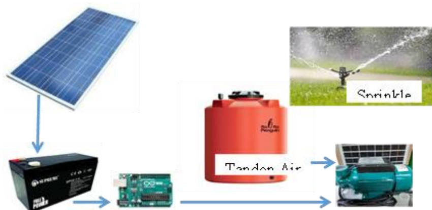
Gambar 1. Karakteristik skema sistem penyiraman otomatis menggunakan pompa tenaga surya
