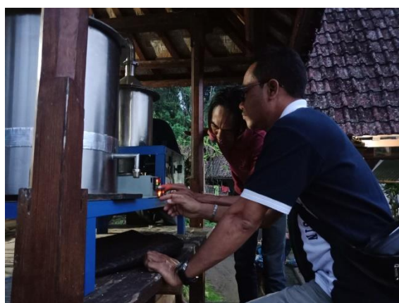
Gambar 7. Pengoprasian alat distilasi dengan alat pengatur temperatur pemanasan
