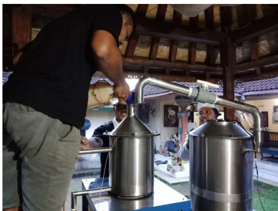
Gambar 6. Memasukan nira yang sudah dipermentasi ke dalam tunggu alat distilasi
