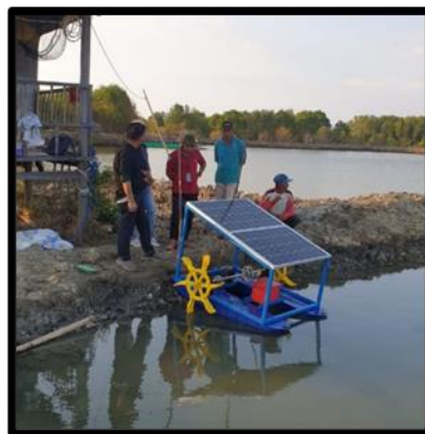
Gambar 6. Penerapan kincir aerator bertenaga surya pada tambak
