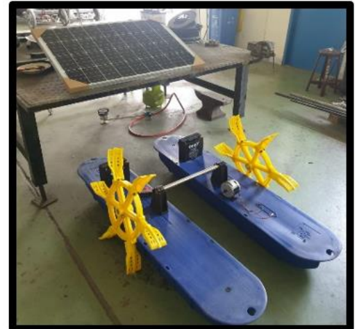
Gambar 2. Perakitan aerator berbasis tenaga surya
