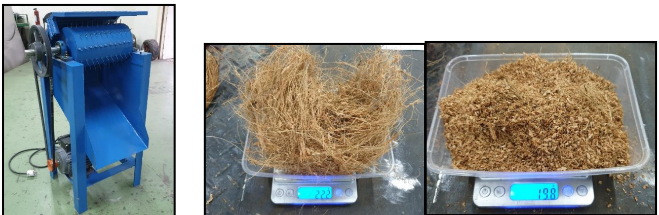
(a) (b) (c) Gambar 3. Pengujian mesin pengurai sabuk kelapa (a) mesin , (b) cocofiber dan (c) cocopeat
