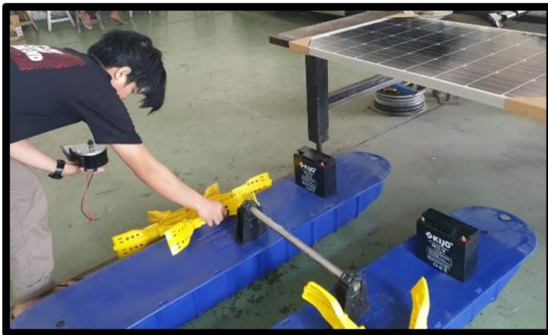
Gambar 2. Perakitan aerator berbasis tenaga surya
