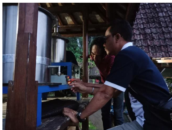
Gambar 7. Pengoprasian alat distilasi dengan alat pengatur temperatur pemanasan
