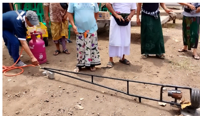
Gambar 3. Kompor kremasi ramah lingkungan yang dibuat untuk desain ruang kremasi di Desa Patemon.
